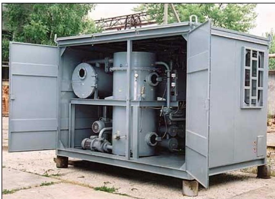
Предназначена для термовакуумной обработки трансформаторного масла с целью удаления газов, воды и механических примесей. Используется при монтаже, ремонте, эксплуатации маслонаполненного высоковольтного оборудования как герметичного, так и негерметичного исполнения напряжением до 1150 кВ включительно (силовые трансформаторы, высоковольтные выключатели и др.). Установка может использоваться для нагрева оборудования горячим маслом и сушки твердой изоляции трансформатора.
